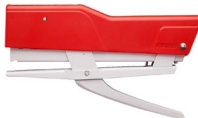
La cucitrice Zenith 590 è leggera, maneggevole e funziona dolcemente. Il corpo e le parti meccaniche sono in metallo, il cappuccio è in plastica ABS antiurto, e la verniciatura utilizza smalti resistenti all'usura e alla corrosione. Cuce a punto chiuso fino a 15 fogli da 80 g con punti 6/4 e 30 fogli con punti 6/6. Capacità di carica di 200 punti.
